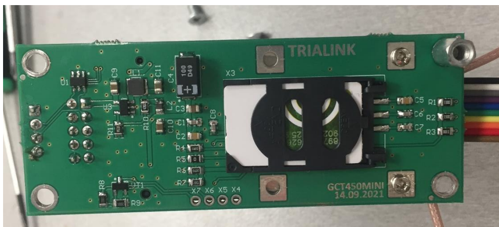
Рис.9 4G модуль GCT450 - место установки SIM-карты с внутренней стороны
